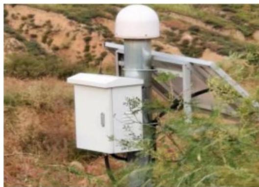
图 5-9GNSS 一体化监测站安装效果图 2
