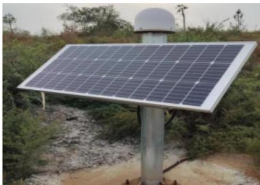
图 5-8GNSS 一体化监测站安装效果图 1
